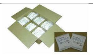
粒径40~80μmの微粉末流動化剤をコンクリート中で溶ける紙でパッキングしてあります。 1パックあたりの重量は235gです。また、段ボール箱1箱あたり30パック入りで、重量は約7kgです。
